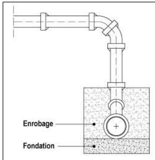
*Exemple d'une chute de raccordement à 45° et d'une chute verticale, avec stabilisations*
